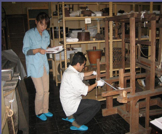
資料の寸法を測定し、劣化症状をチェックする。各部位の寸法と劣化症状の特徴などはデジタル画像の打ち出しに直接記入する。
